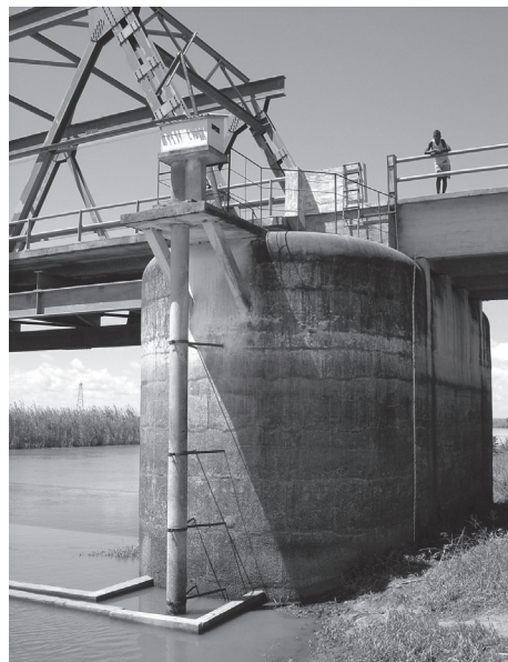
Flödesstation i Pungwefloden, Moçambique. Vattennivån avläses och omräknas via en avbördningskurva till ett flöde.
