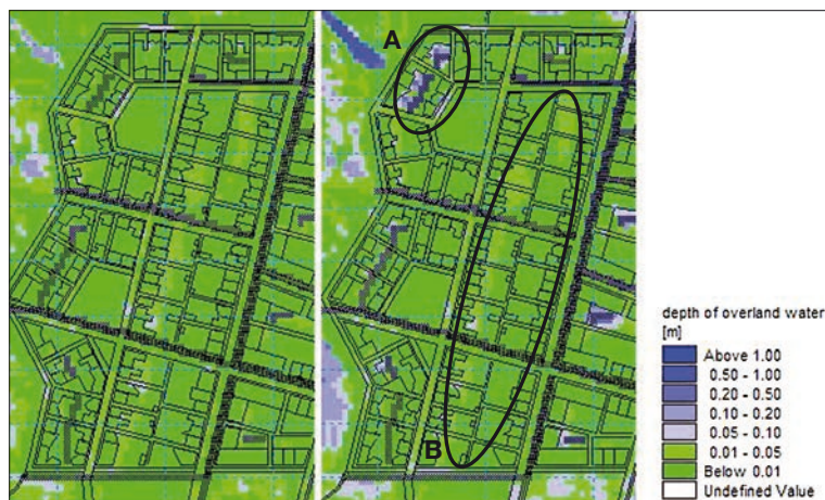
Figur 5. Modellresultat för bostadskvarteren närmst kusten. Vänster bild visar minlösningen med 10-årsregn och höger med 100-årsregn. Bilderna visar området två timmar efter regnens maxintensitet. Svackdiken visas som skuggade områden och markeringar beskrivs i text.
