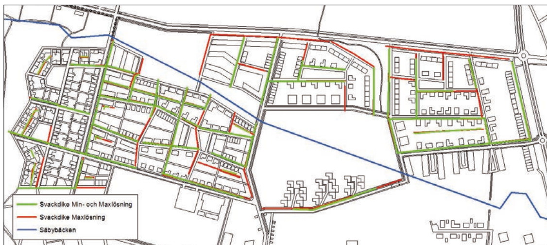
Figur 3. Max- och minlösning för dagvattenhantering med svackdiken i Norra Borstabusen. Gröna linjer visar placeringen av svackdiken i max- och minlösningen och röda linjer visar där ytterligare svackdiken finns i maxlösningen. Säbybäcken visas som blå linje.
