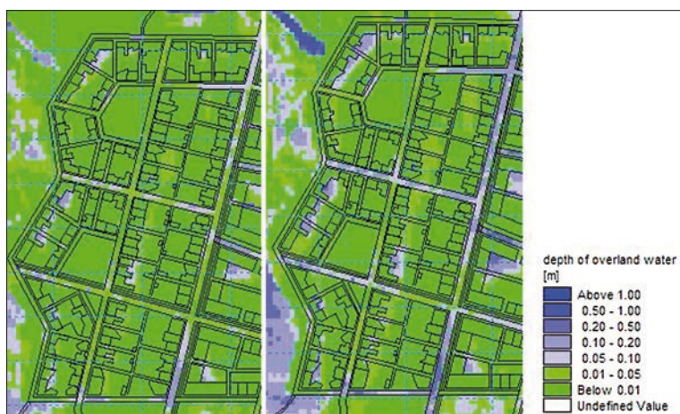
Figur 4. Modellresultat för bostadskvarteren närmst kusten simulerat utan dagvattenhantering. Till vänster visas området simulerat för ett 10-årsregn och till höger med ett 100-årsregn. Blå markering visar vatten över 5 cm djup.
