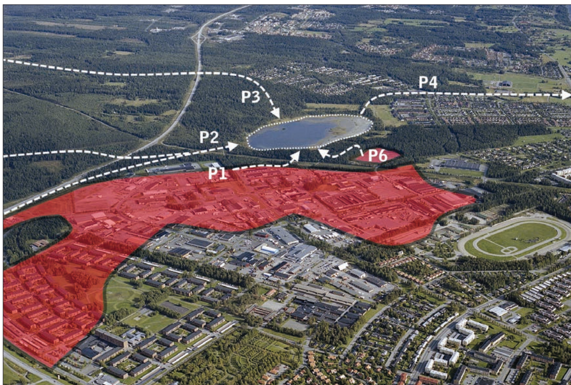
Figur 2. Dagvatten från Odenskogs handels- och industriområde (markerat område) avrinner genom utjämningsmagasin och miljödamm till Lillsjön (utloppet i Lillsjön är provtagningspunkt P1). Det uppskattas att 25 % av dagvattnet leds till Lillsjön och 75 % via dagvattenledningar till Storsjön. Smältvatten från snötippen genomgår rening i smältvattendamm (P6) samt översilar ett mindre våtmarksområde i anslutning till sjön. Överbäcken (P3) är det största biflödet till sjön, och Odensalabäcken (P4) är sjöns utlopp till Storsjön.
