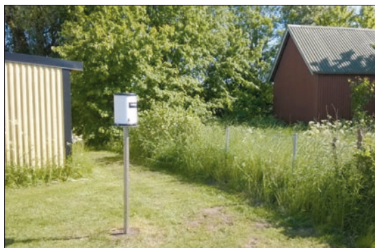
Figur 1. Markinstallation av regnmätare Casella.
