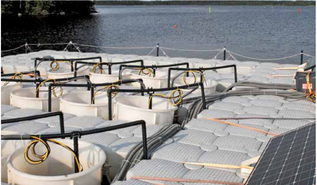
Figur 5. En av de flytande plattformarna som innehåller 16 stycken mesokosmer, med sensorer som bevakar temperatur, pH, syre, ljus och klorofyll.
