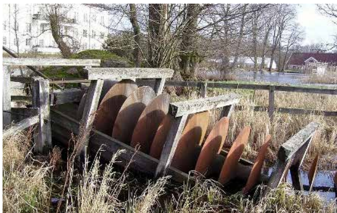
Figur 4. Principen för Arkimedes skruvpump, vid Huseby slott.
