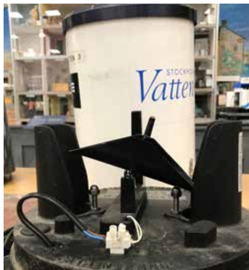
Figur 1. Regnmätare av vippskålstyp. Foto Carl Jonsson.
