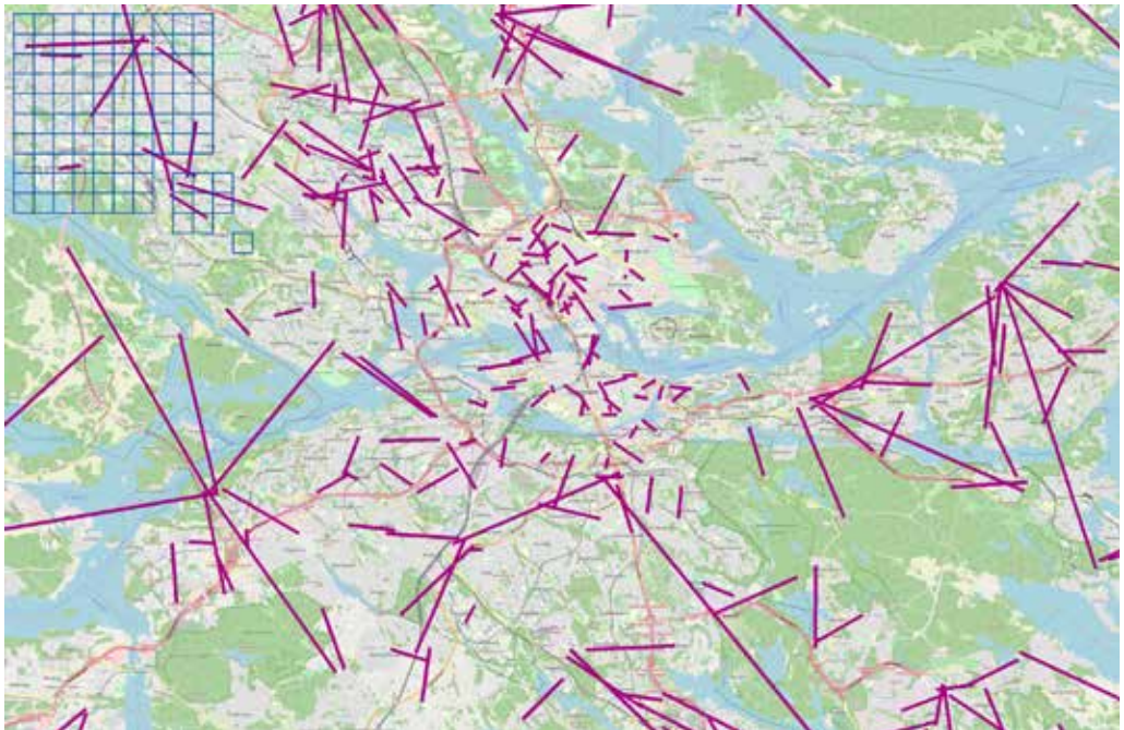
Figur 4. I figuren visas placering av länkar i en mobiloperatörs nät runt centrala Stockholm. Som en illustration visas cellstorlek, 500x500 m, för det grid som beräknas utifrån länkarnas mätningar. Fler länkar finns i andra operatörers nät. Länkarnas läge är något modifierade.
